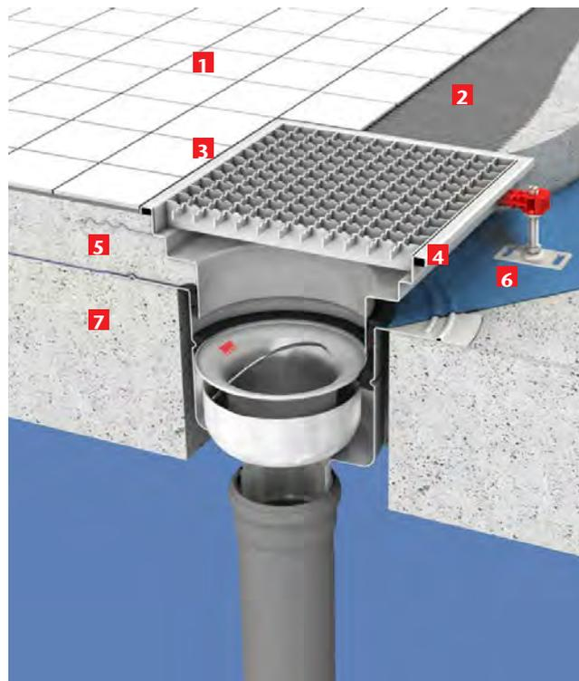
**Vasca ACO e pozzetto ACO con flangia meccanica (pavimento piastrellato)**
