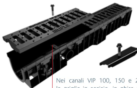
Nei canali VIP 100, 150 e 200, le griglie in acciaio, in ghisa e in poliammide vengono fissate al canale tramite **barretta** con vite. Quelle in PP-PE, invece, si fissano ad incastro grazie ad una linguetta laterale. Il canale **VIP 300** richiede il fissaggio delle griglie con bulloni.
