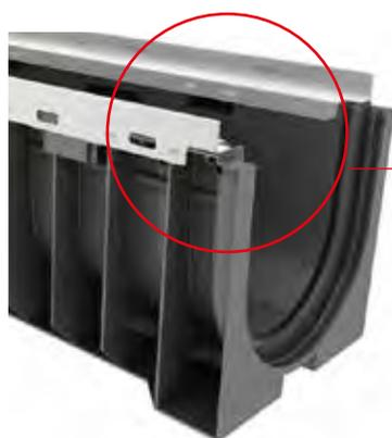
Il telaio di rinforzo in acciaio è alto 20 mm e ha uno spessore di 2,5 mm nella parte esposta al transito dei veicoli. Contiene la griglia e facilita la posa in opera del canale.
