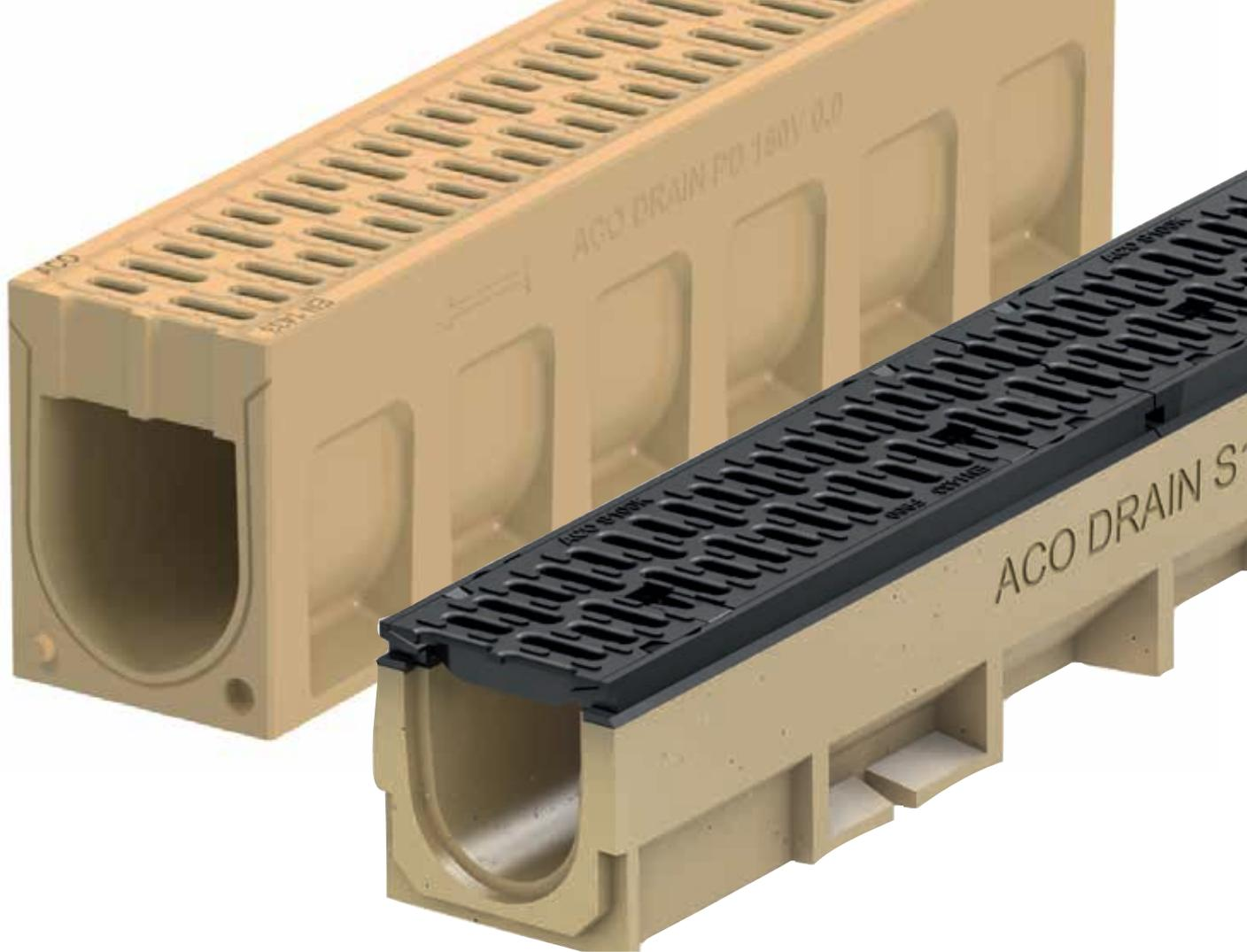
ACO Polymerbeton besteht zum überwiegenden Teil aus natürlich vorkommenden mineralischen Rohstoffen, wie z.B. Quarz, Basalt und Granit. Sie werden in Form von Sanden und Kiesen bestimmter Korngrößenzusammensetzungen (Sieblinien) mit einer Kunstharzmatrix gebunden.
