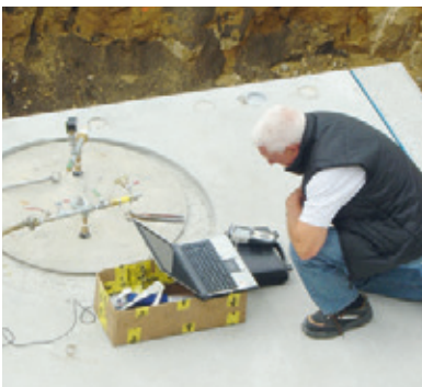
Druckluftprüfung auf Dichtigkeit
