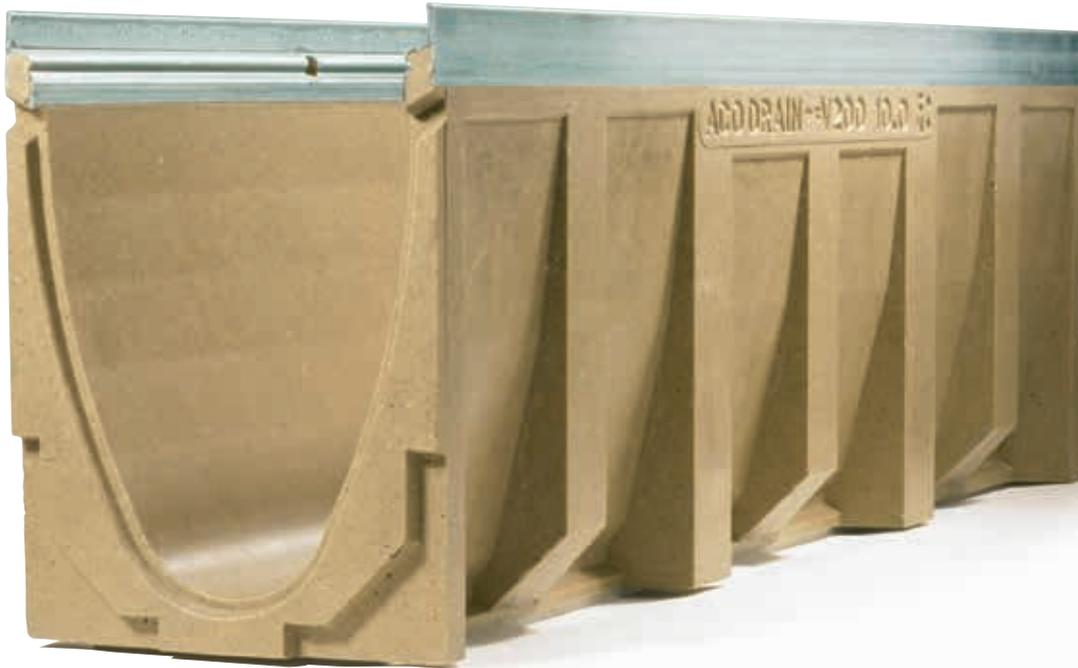
ACO Polymerbeton besteht zum überwiegenden Teil aus natürlich vorkommenden mineralischen Rohstoffen, wie z.B. Quarz, Basalt und Granit. Sie werden in Form von Sanden und Kiesen bestimmter Korngrößenzusammensetzungen (Sieblinien) mit einer Kunstharzmatrix gebunden.
