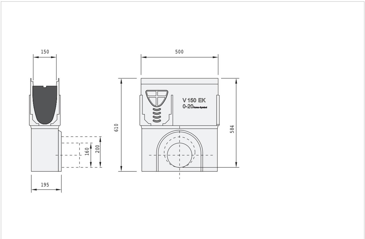
Einlaufkasten ACO DRAIN® Multiline V 150
