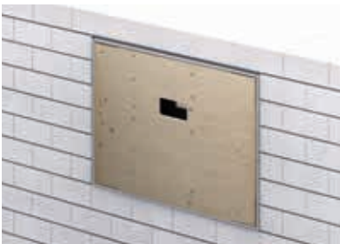
4. Aussteifungen erst nach Erhärten des Mörtels entfernen.
