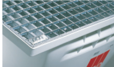
Maschenrost, Maschenweite 30 x 30 mm, begehbar bis 1,5 kN
