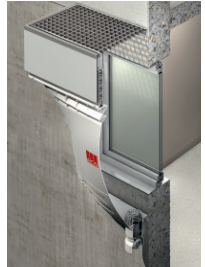
Kombination aus fixem und variablem Aufstockelement
