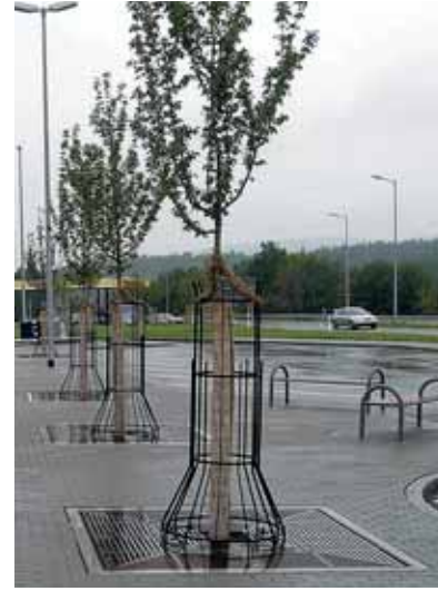
In der Anwachszeit können die jungen Bäume am Baumschutzgitter gegen Windlast befestigt werden
