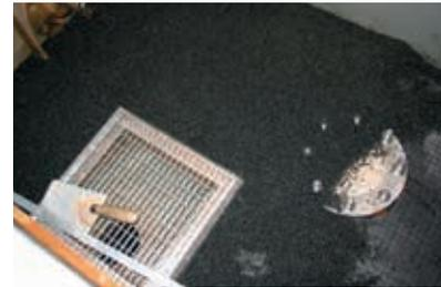
Prüfungsaufbau mit Dränagematte und Splittbett vor dem Aufsatz
