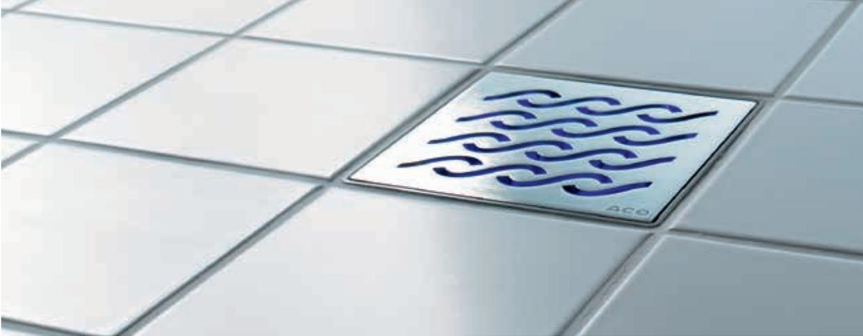
Die Punktentwässerung bietet eine höhere Ablaufleistung (0,8 l/s bzw. 48 l/min) als die Linientwässerung. Beim Einbau eines Badablaufs muss deshalb unbedingt ein vierseitiges Gefälle zum Ablauf hin gefliest werden, damit das Schmutzwasser direkt abfließt.
