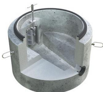
As quantidades descarregadas no sistema ACO Stormbrixx são ajustadas e controladas através da câmara de restrição de fluxo ACO, uma estrutura de poço de inspeção feita de concreto armado com uma válvula de restrição de fluxo integrada para redução da seção da tubulação de descarga. Desta forma, a água superficial coletada é descarregada no esgoto de maneira controlada, sem sobrecarregá-lo.
