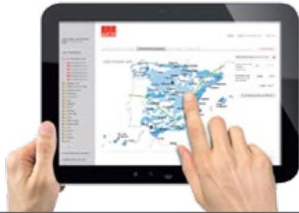
A ACO desenvolveu o software para modelar o comportamento hidráulico em um canal de drenagem, de acordo com o princípio de escoamento variado. O programa é guiado quanto ao seu algoritmo por um conjunto de equações diferenciais, onde as informações resultantes são a velocidade e a lâmina de água.
